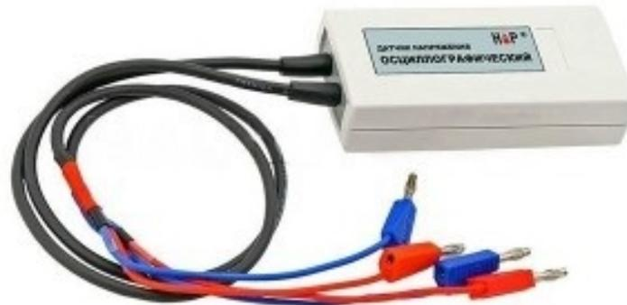
**Двухканальная приставка-осциллограф** предназначена для исследования формы электрических сигналов по двум каналам путём визуального наблюдения и измерения их амплитуд и временных интервалов. Приставка является упрощённым аналогом электронного осциллографа и предназначена для использования в учебном процессе.
